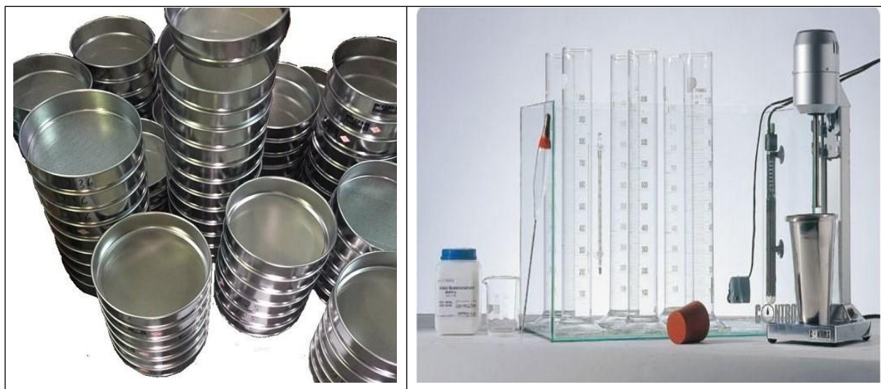
Hình 6: Thiết bị thí nghiệm thành phần hạt/ Fig. 6: Apparatus for partial size distribution test
