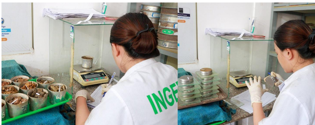
Hình 10: Dụng cụ thí nghiệm dung trọng tự nhiên/ Fig. 10: Apparatus for unit weight test
