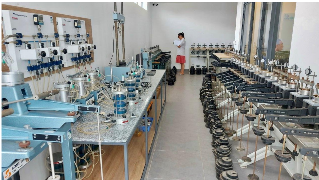
Hình 12: Dụng cụ thí nghiệm nén lún/ Fig. 12: Apparatus for compression test
