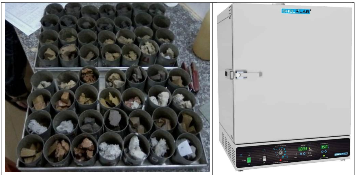
Hình 8: Dụng cụ thí nghiệm độ ẩm/ Fig. 8: Apparatus for water content test
