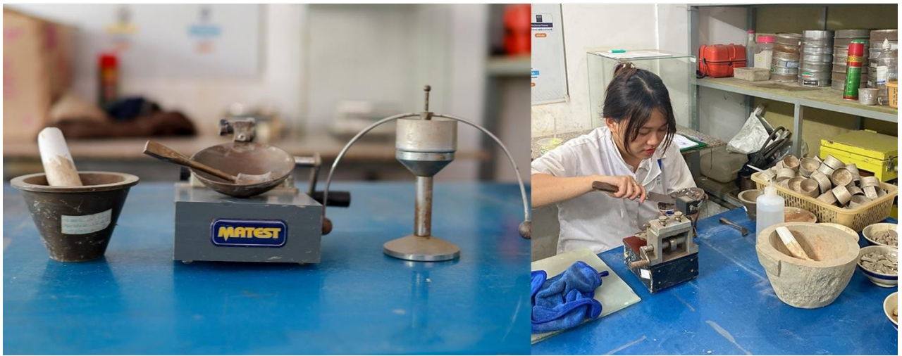
Hình 7: Thiết bị xác định giới hạn Atterberg/ Fig. 7: Apparatus for Atterberg limit test
