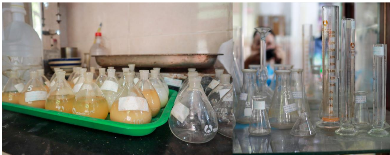
Hình 9: Dụng cụ thí nghiệm tỷ trọng/ Fig. 9: Apparatus for specific gravity test
