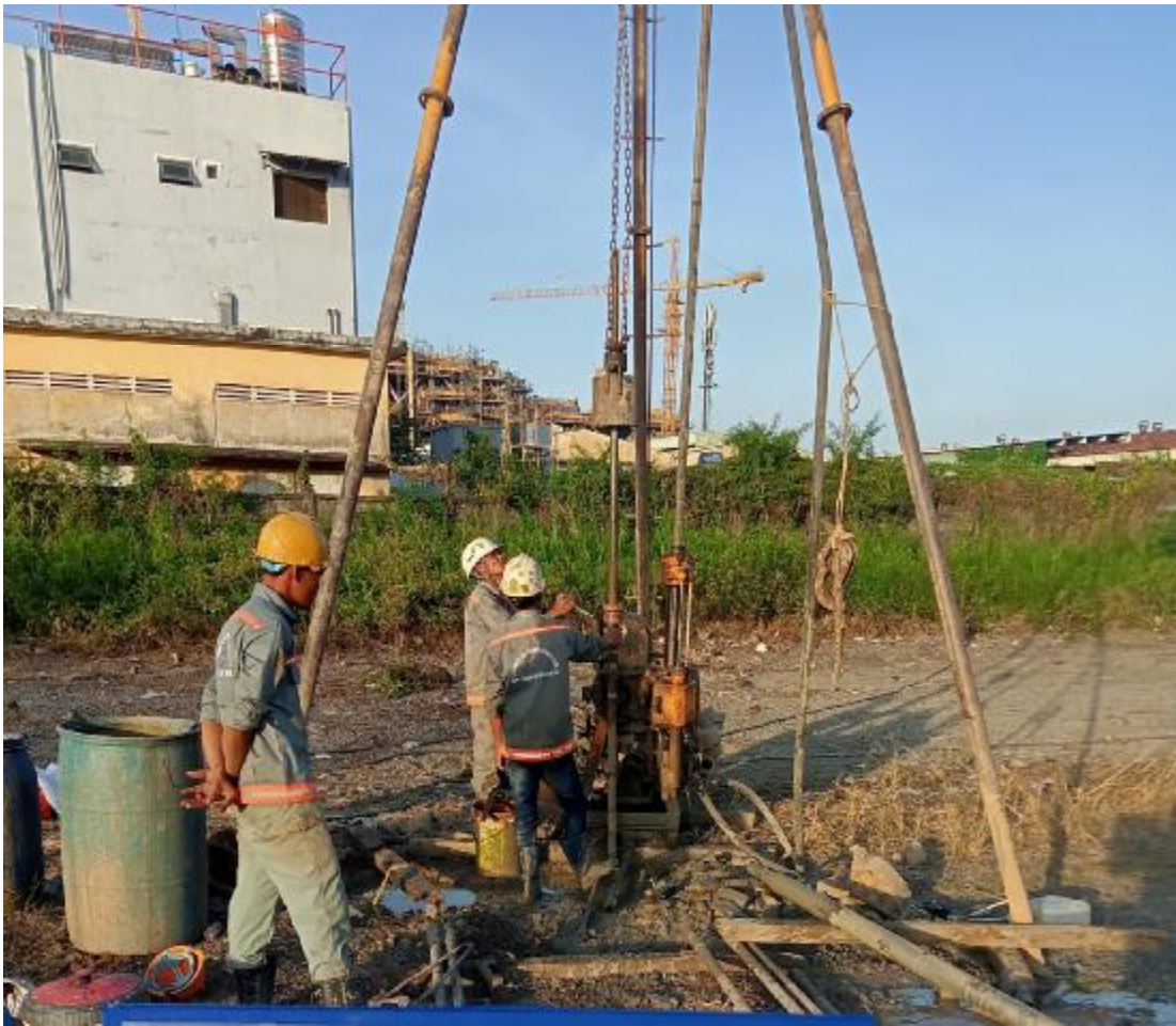
Thí nghiệm SPT tại hố khoan HK1
