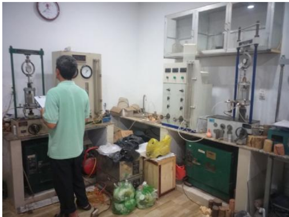
Thí nghiệm nén 3 trục UU
