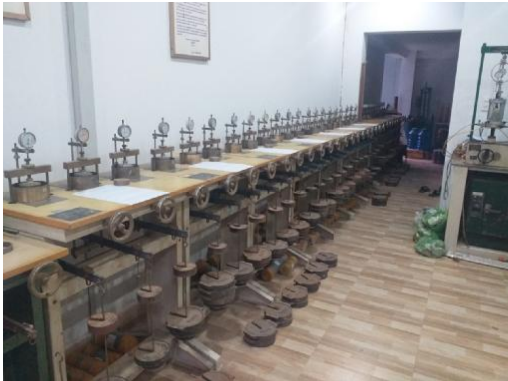
Thí nghiệm nén nhanh trong phòng thí nghiệm
