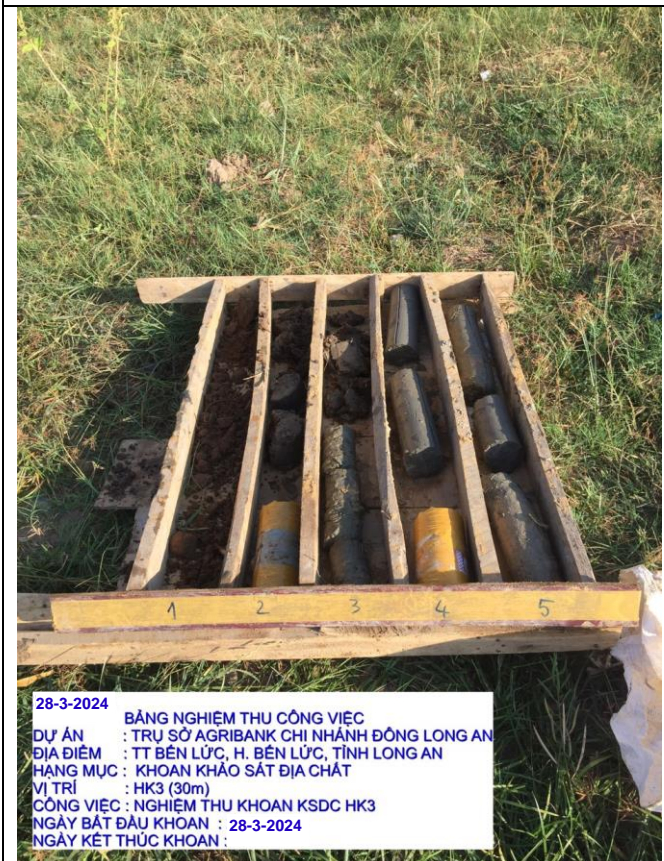
28-3-2024 BẢNG NGHIỆM THU CÔNG VIỆC DỰ ÁN : TRỤ SỞ AGRIBANK CHI NHÁNH ĐÔNG LONG AN ĐỊA ĐIỂM : TT BẾN LỨC, H. BẾN LỨC, TỈNH LONG AN HẠNG MỤC : KHOAN KHẢO SÁT ĐỊA CHẤT VỊ TRÍ : HK3 (30m) CÔNG VIỆC : NGHIỆM THU KHOAN KSDC HK3 NGÀY BẮT ĐẦU KHOAN : 28-3-2024 NGÀY KẾT THÚC KHOAN :
